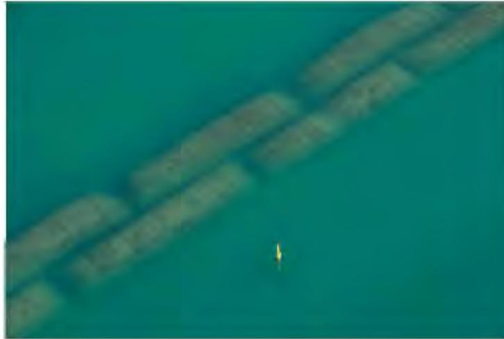
2,4 km d'atténuateur de houle à 350 m au large immergé par 4,5 m de fond
